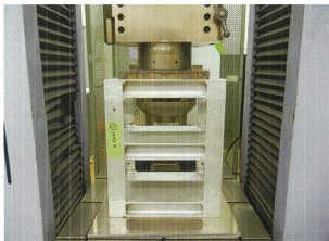
図1 試験品の設置状況（記号A 300x400を底面とする状態）
